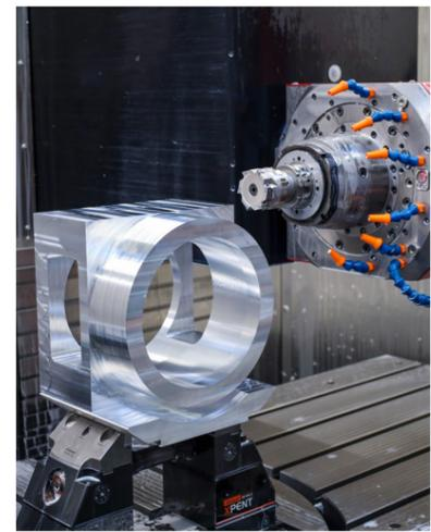
Komplexe Mehrseitenbearbeitung fertigen wir mit unserem 5-Achsen Bearbeitungszentrum Hermle C30, welche mit einer Erowa Palettisierung ausgerüstet ist. Mit dieser Anlage können hochkomplexe Teile mit einer sehr hohen Teilequalität hergestellt werden. Es werden damit vorwiegend kubische Teile unterschiedlicher Grösse bearbeitet vom Kleinteil 10 x 10 x 10 mm bis 300 x 300 x 300 mm.
